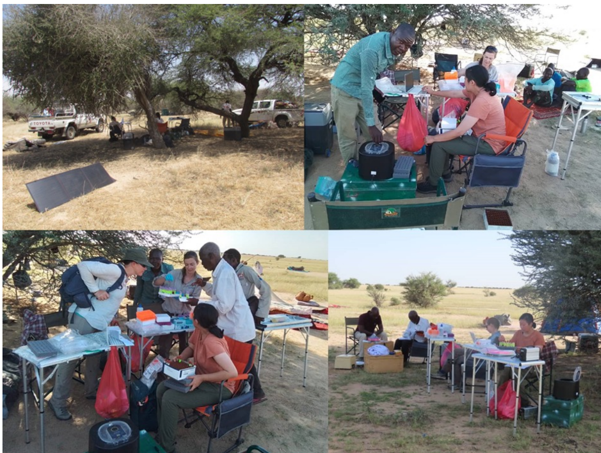
Fig. 26. Laboratoire mobile utilisé pour traiter les échantillons recueillis au cours de la mission terrain. Parmi le matériel à disposition : le nécessaire d'échantillonnage, des centrifugeuses, congélateurs et générateurs portables, des panneaux solaires et des fournitures de bureau de base.
