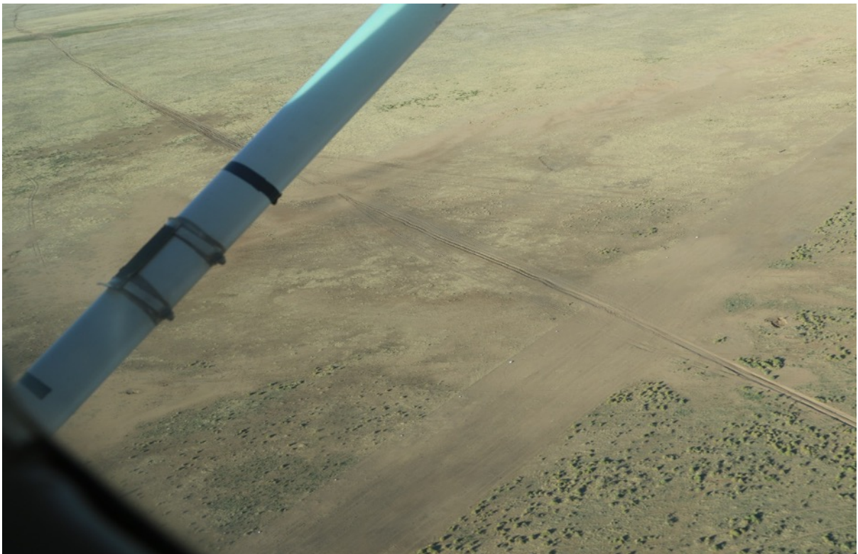
Photo I. Photo illustrant la difficulté d'utiliser une bande de ruban adhésif sur le hauban de l'aile pour évaluer la largeur de la bande. Des marqueurs blancs sur le bord de la piste d'atterrissage sont placés à des intervalles de 20 m.
